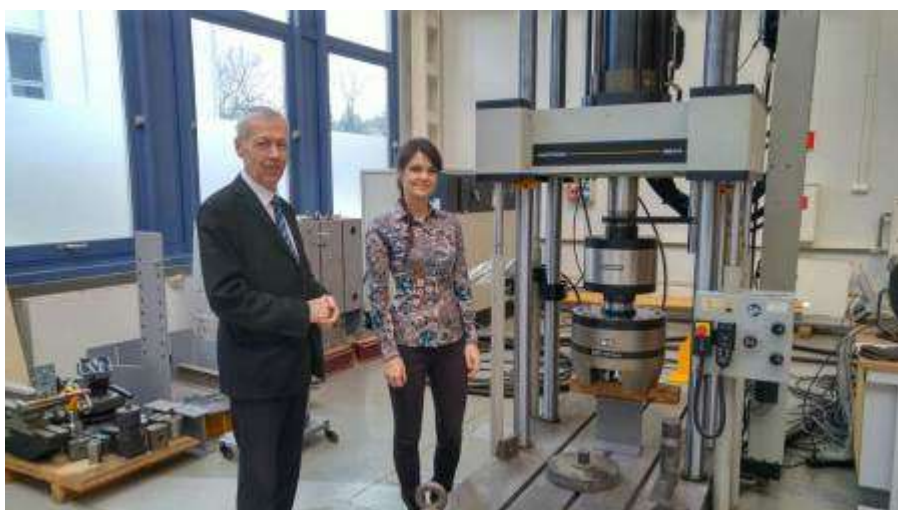
Испытательная машина Instron 8804 мощностью \pm 500 кН с оптической системой для измерения деформации Понта и Арамис 3D и дополнительный привод \pm 500 кН КИП и стальная рама
