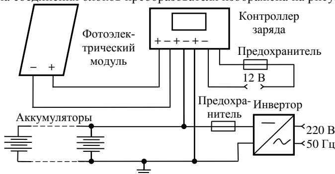
Рисунок 1 – Схема соединения блоков преобразователя
